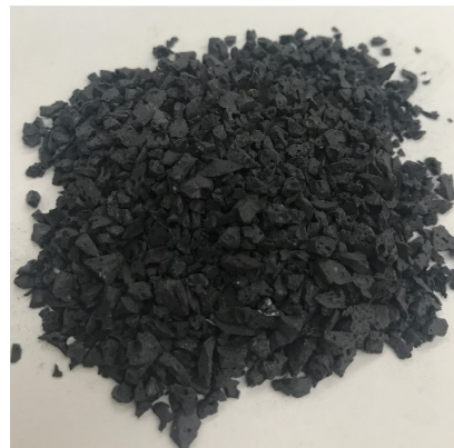
図 10：細かく破砕した焼結体
