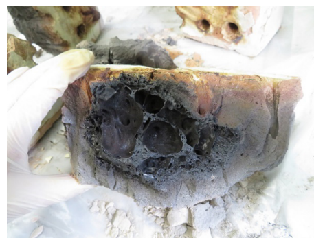
図 9：冷却・破砕した焼結体
