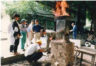
図 たたら製鉄の様子。
